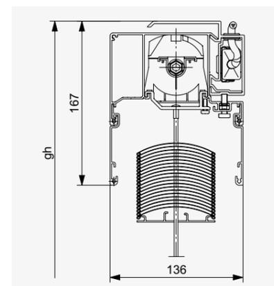
Box avec paquet de lames apparent
